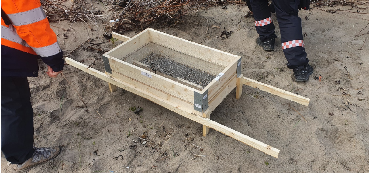
Figur 4. Såldekasse hvor to personer rister på hver sin side.
