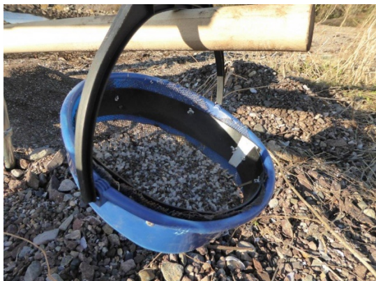
Figur 24. Modifisert bøtte med nett kan brukes som en sikt
