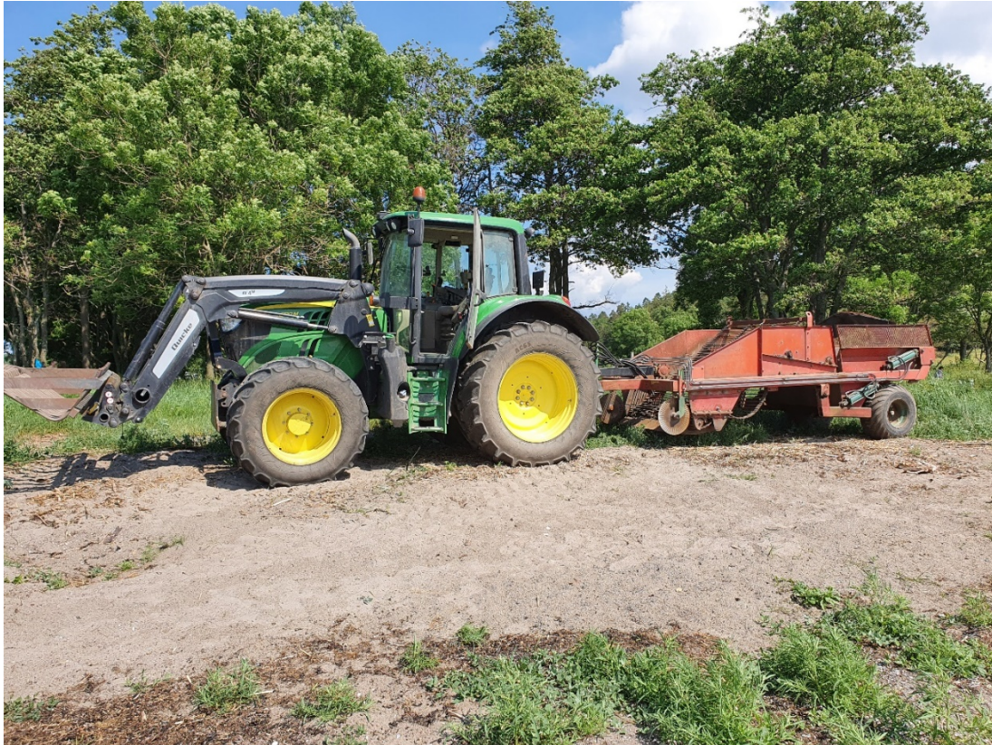
Figur 23. Traktorsålding med utstyr som hadde for stor avstand mellom ristene.
