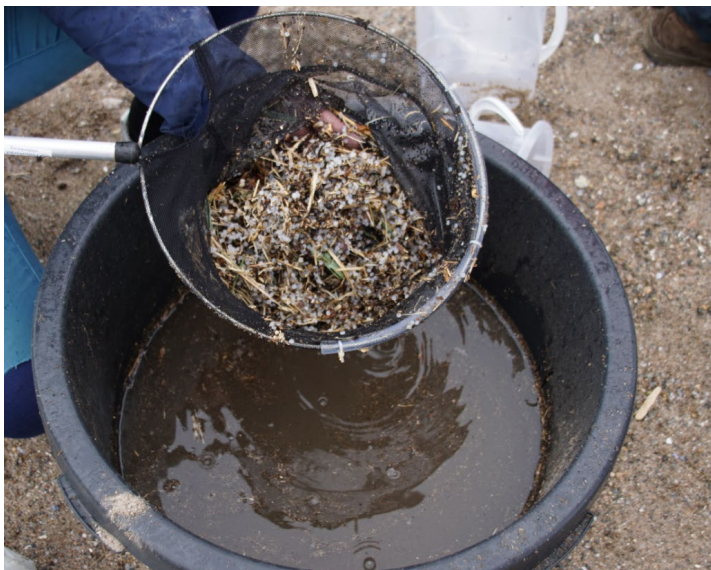
Figur 10. Etter sålding, deretter vannbad i bøtte når partikkelstørrelse og pellets har lik størrelse.
